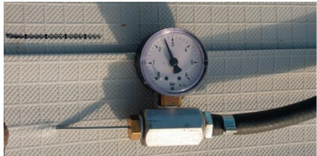
Manometer mit Nadel (Prüfdruck: 2,5 bar)
