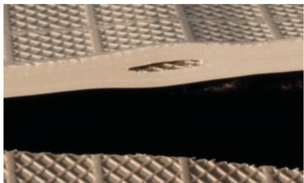
Schnitt durch die Schweißnaht und Blick auf den Prüfkanal
