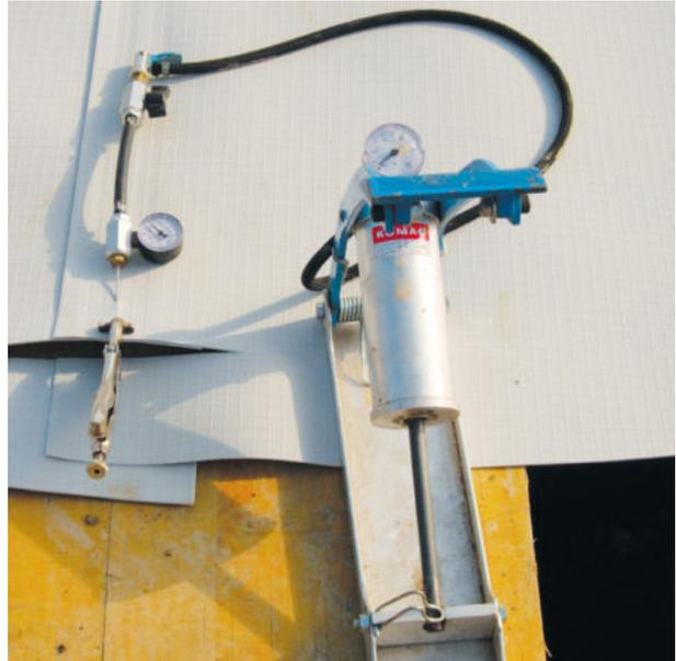
Druckluftprüfung mit Fußpumpe
