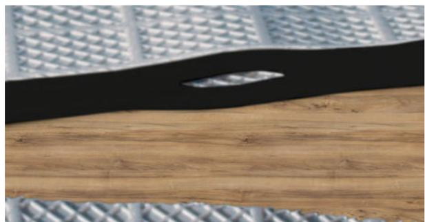
Schnitt durch die Schweißnaht und Blick auf den Prüfkanal
