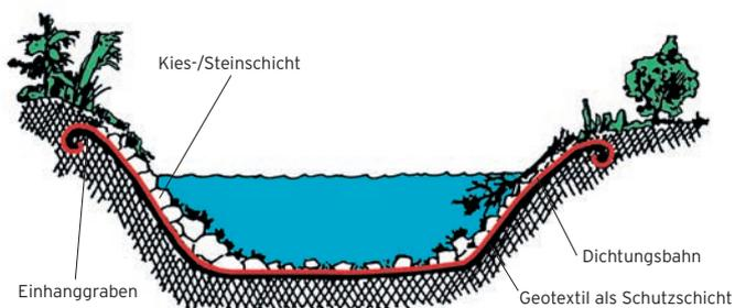
Schema eines Teiches mit SCHEDETAL Dichtungsbahn
